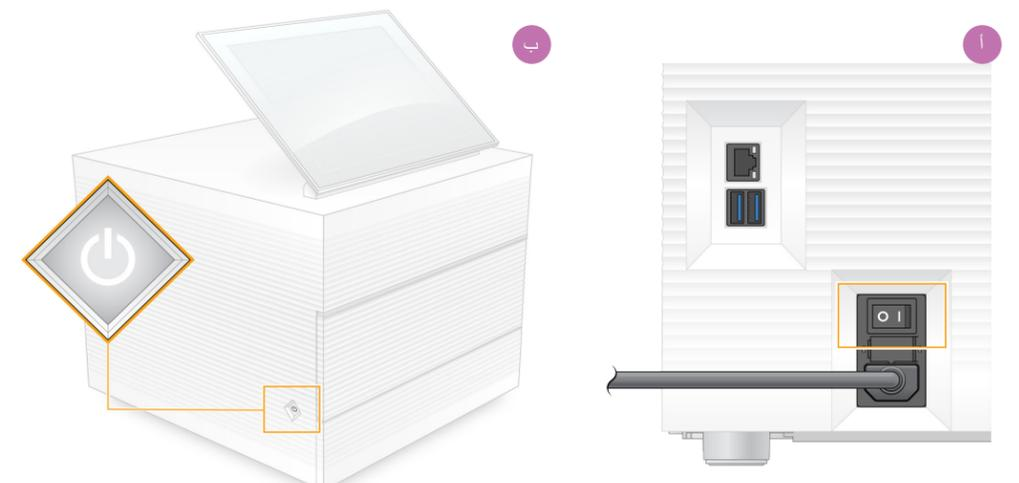
أ أدر مفتاح الفصل الكهربائي الموجود بالجزء الخلفي من الجهاز إلى وضع التشغيل (I).
