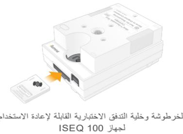
الخرطوشة و خلية التدفق الاختبارية القابلة لإعادة الاستخدام لجهاز iSEQ 100
