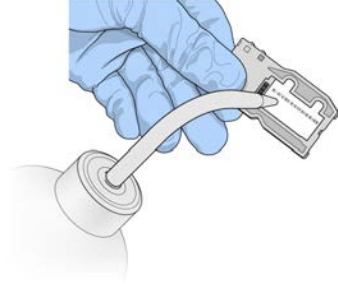
Figura 10 Risciacquo della cella a flusso
