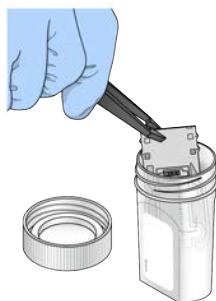
Figura 9 Rimozione della cella a flusso
